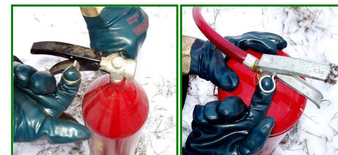
3. Взять огнетушитель одной рукой за рукоятку, а другой за шланг. Если расструб присоединен к огнетушителю трубкой – перевести его в горизонтальное положение.
