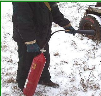
4. Подойти с наветренной стороны как можно ближе к горящему оборудованию или объекту. Направить расструб на очаг загорания и, нажав на рычаг пускового устройства, привести огнетушитель в действие
